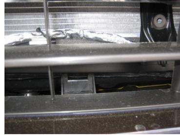
Dirigez le harnais autour du côté droit du radiateur et du condensateur vers l'avant du véhicule. À l'aide d'une attache noire incluse dans l'ensemble, reliez le harnais du chauffe-moteur au support du condensateur du climatiseur tel que montré.
