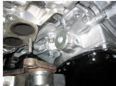
Localisez le bouchon expansible fileté de 36mm sur le côté droit du moteur.
