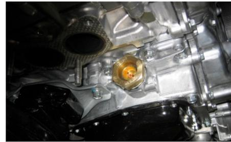
Installez le chauffe-moteur dans l'ouverture du bouchon expansible et le serrer avec les pinces jusqu'à ce que le joint d'étanchéité soit bien assis sur le bloc-moteur.
