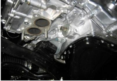
Insérez la douille hexagonale de 14 mm dans le bouchon expansible et desserrez.
