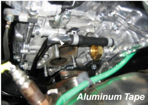
En utilisant le ruban en aluminium fourni, enveloppez la ligne du liquide de refroidissement de la transmission TVC près du point où il se rattache au tuyau de caoutchouc.
