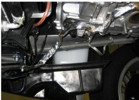
Branchez le harnais dans l'élément de chauffe-moteur. Dirigez le connecteur orange vers l'avant en le vrillant à l'intérieur du chauffe-moteur. L'intérieur du chauffe-moteur peut-être pivoté par rapport au boîtier extérieur.
