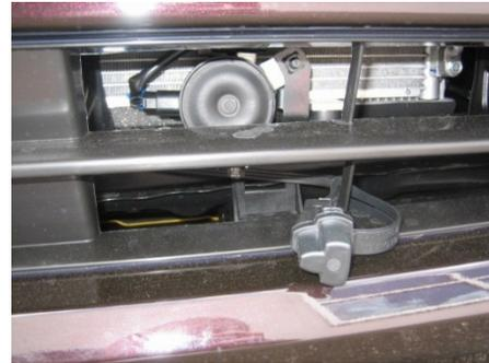
À l'aide de la courroie protectrice du connecteur mâle, attachez le connecteur mâle à la calandre dans la région de l'entrée d'air inférieure.
