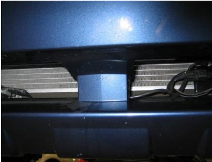
Dirigez le harnais du chauffe-moteur devant le condensateur du climatiseur et derrière le support vertical de l'ouverture inférieure d'entrée d'air.
