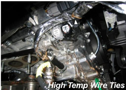
En utilisant l'attache haute température couleur or fourni, attachez le harnais du chauffe-moteur à la section enveloppée de la ligne du liquide de refroidissement de la transmission TVC. Dirigez le harnais au- dessus des connecteurs électriques du capteur d'oxygène. Utilisez la deuxième attache haute température couleur or pour attacher le harnais du chauffe-moteur au harnais du moteur à côté du connecteur noir du capteur d'oxygène.
