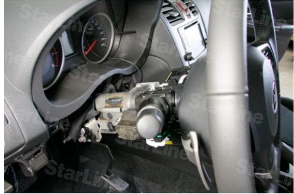
Фото 2.4. Рулевой кожух снят
