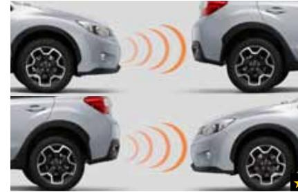
**65** Ultraschall Einparkhilfe für hinten / Ultraschall Einparkhilfe zur Erweiterung für vorne
